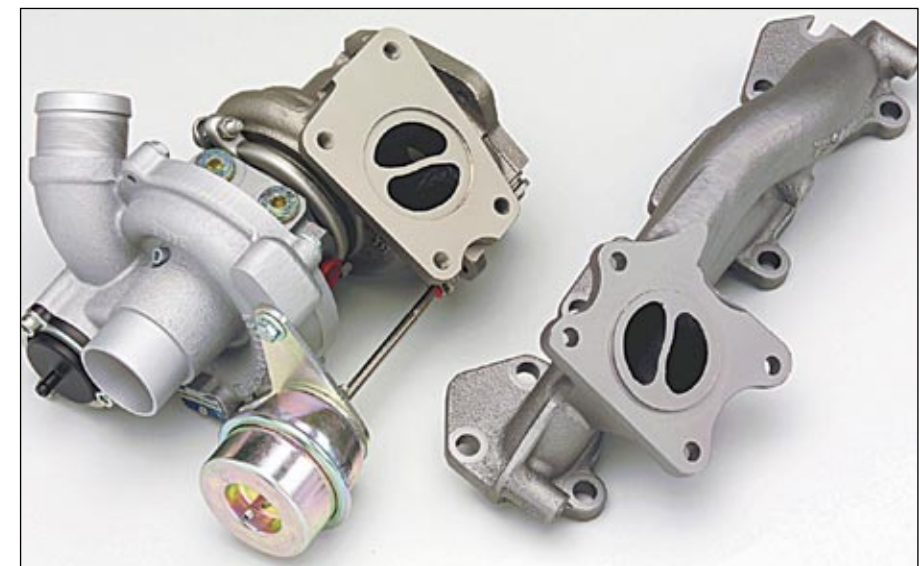
Turbo con válvula "waste gate", y colector de escape con doble conducto denominado "Twin scroll", que se utiliza en el motor de nafta/gasolina.
