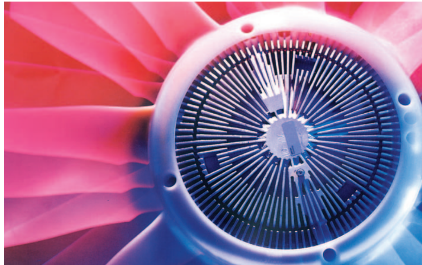
Ventilador de accionamiento viscoso – eléctrico, basado en la sensibilidad de la silicona en función de la temperatura –Behr.
