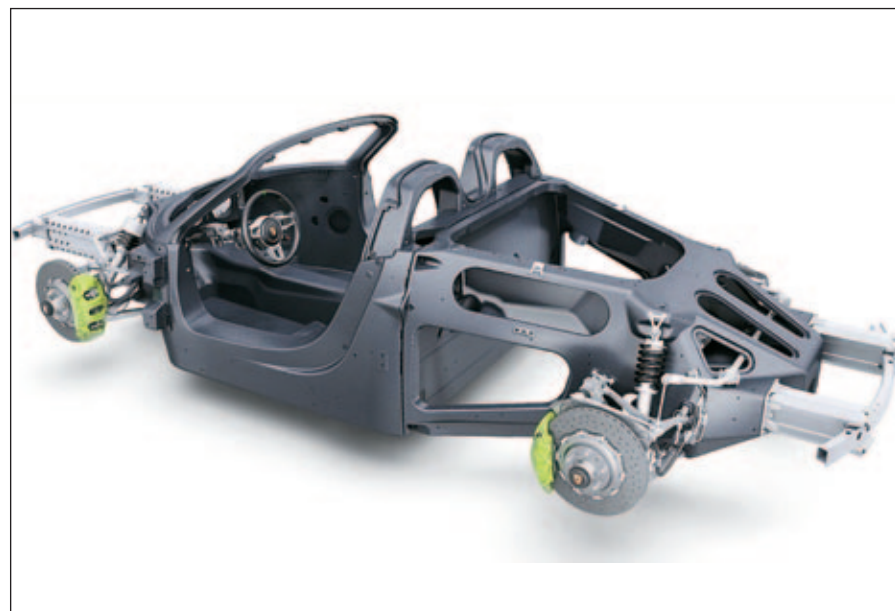
La estructura portante en su núcleo, está construida en fibra de carbono, completada por dos falsos chasis de aluminio.
