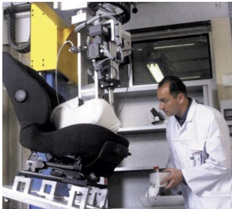
Se realizan muchos ensayos sobre los asientos que están en desarrollo. Prueba de durabilidad en un centro de investigación y experimental.
