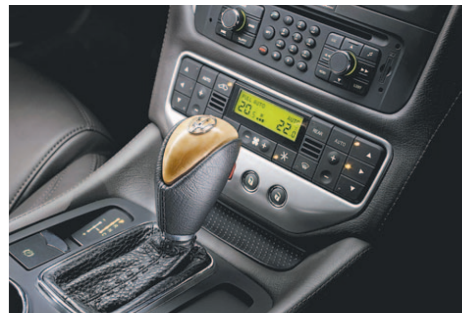
Transmisión: automática de seis velocidades (ZF 6HP26) con cambio automático de MC.
