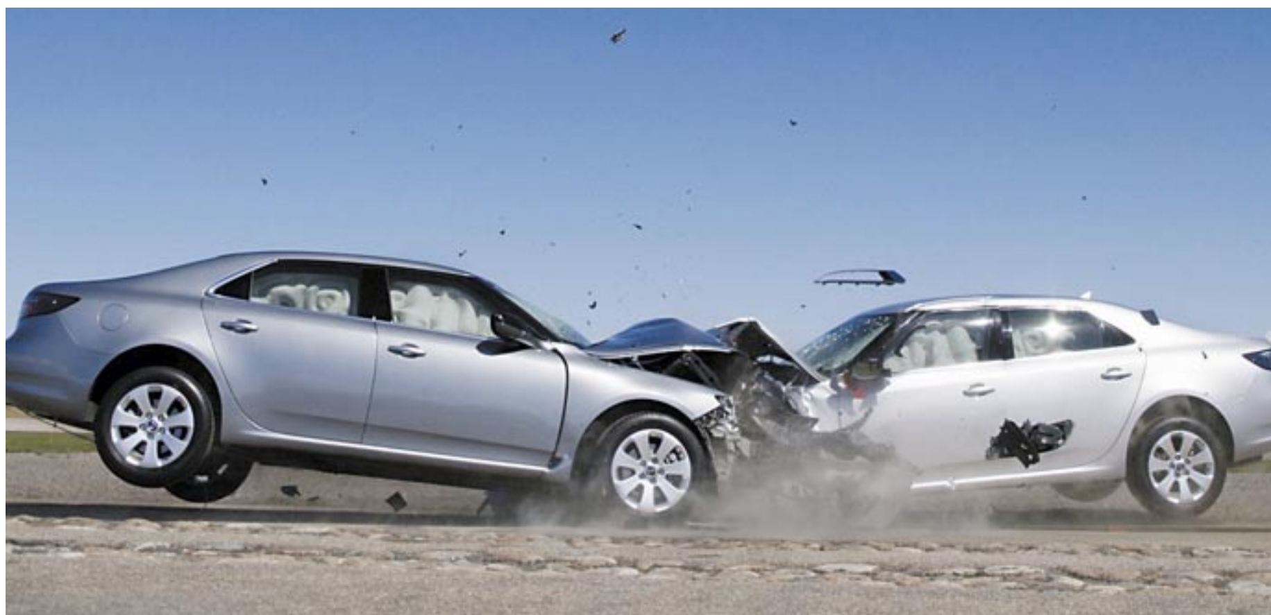
Dos automóviles Saab 9.5 chocan de frente a una velocidad de 120 km/h., en el momento del impacto, son las estructuras que lo absorben por deformación.
