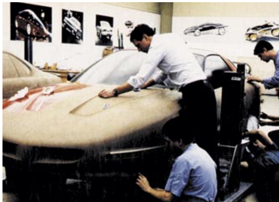
Maqueta realizada en arcilla, en "tamaño real", donde trabajan todos los especialistas.
